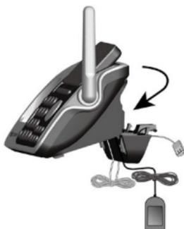
4. Branchez le cordon de la ligne téléphonique (ou du filtre ADSL) dans la prise murale. Branchez l'adaptateur d'alimentation dans une prise de courant qui n'est pas contrôlée par un interrupteur mural. Aligner les deux encoches à l'arrière de la base du téléphone avec les goujons de la plaque de fixation murale. Assurez-vous que le cordon de la ligne téléphonique n'est pas coincé entre la plaque de fixation murale et la base du téléphone.
